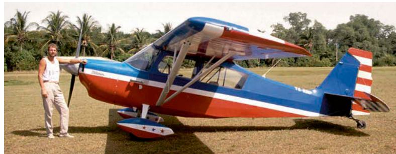
Die Bellanca Decathlon ist ein leichtes, zweisitziges kunstflugtaugliches Sportflugzeug mit einer Reichweite von etwa 1000 Kilometern und einer Höchstgeschwindigkeit von 255 km/h bei einer Leistung von 134 KW. RS-Fotos: Bundschuh
